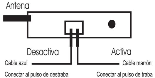
Es conveniente instalar la unidad en un lugar inaccesible debajo del tablero. No debe montarse en el habitáculo del motor.
